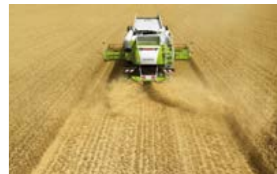
48-р зураг: Сүрлийг комбайны авцын өргөн хэмжээгээр жигд цацаж буй байдал (Эх сурвалж: зохиогч).
