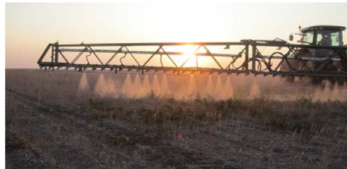
46-р зураг: Химийн уриншид AmaSpot шүршигчээр хог ургамалтай тэмцэх цэгэн устгал хийж байгаа нь (Эх сурвалж: зохиогч).
