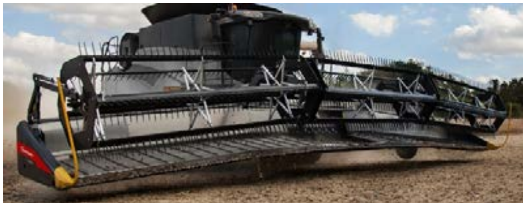
47-р зураг: Талбайн гадаргууд сайн зохицох уян хатан жатка (Эх сурвалж: зохиогч).
