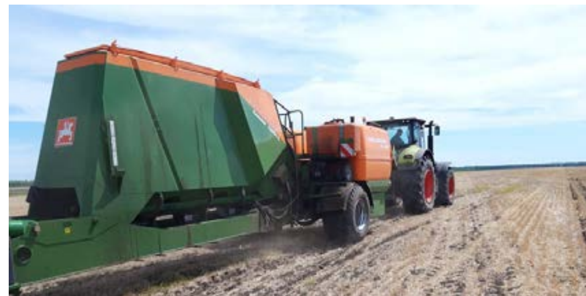
38-р зураг: Трактор ба үрлэгчийн хооронд угсарсан шингэн бордооны чиргүүл. (Эх сурвалж: зохиогч).
