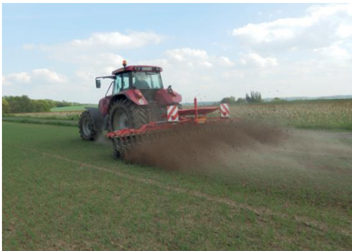
Зураг 4: Од хэлбэрийн эргэдэг цант сэндчилүүр шавранцар хөрсний нягтарсан өнгөн давхаргыг сийрүүлэх чадвар сайтай бөгөөд шүдэт борнойтой хослуулж ашиглахад тохиромжтой (Эх сурвалж: Маркус Мюке, Нийдерзаксен мужийн ХАА-н танхим)
